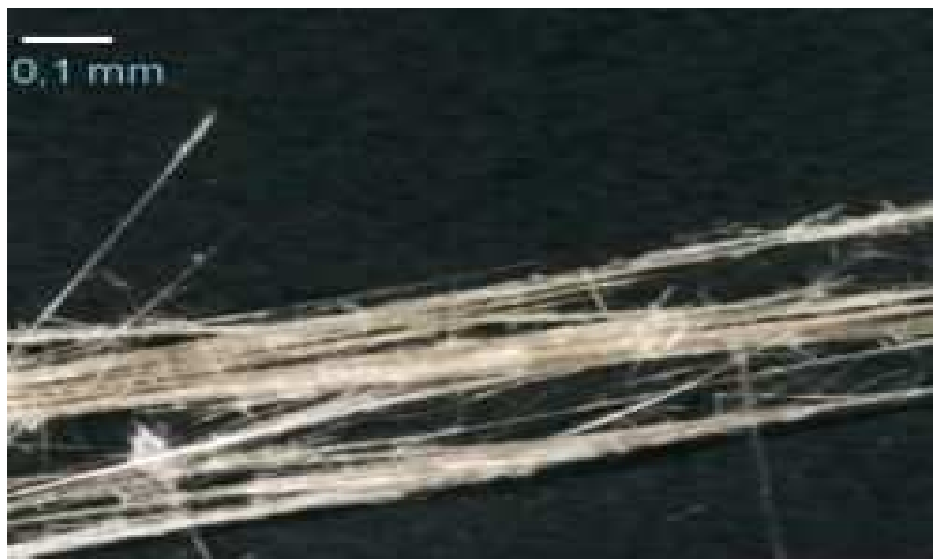
Zdjęcie 2. Azbest amozytowy (grupa azbestów amfibolowych)
