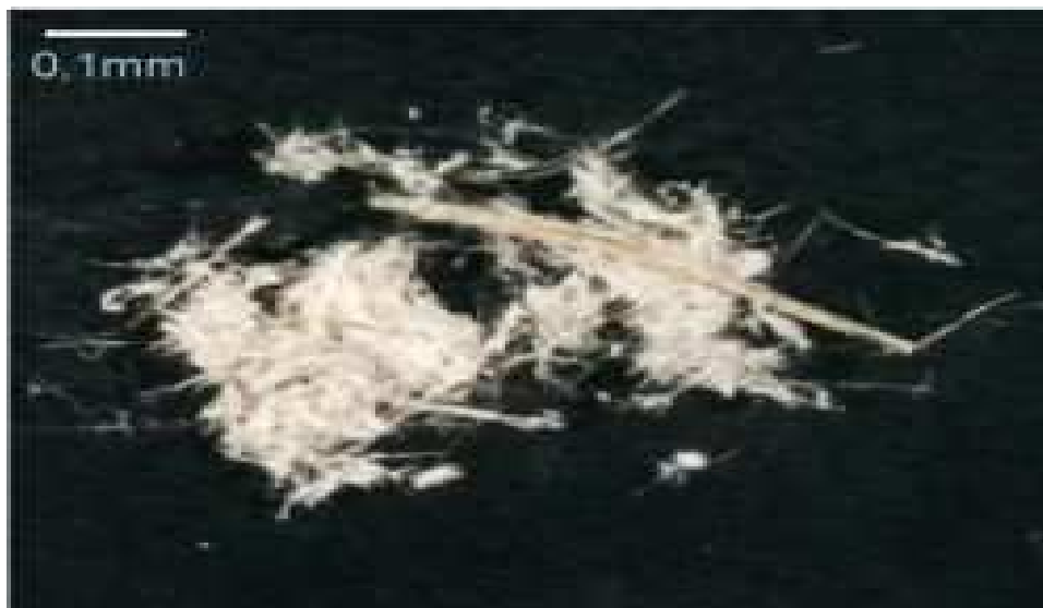
Zdjęcie 1. Azbest chryzotylowy tzw. twardy, krótkowłóknisty, zawiera \text{CaCO}_3
