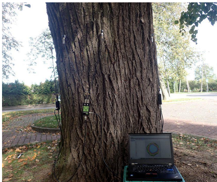
Fot.72 Czujniki tomografu z okablowaniem
